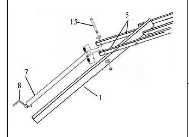
ШАГ 9. Зафиксируйте опорную стойку (1) на крепёжной пластине (26).
